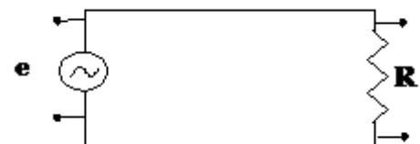
Figura III: circuito compuesto de una fuente de tensión alterna y una resistencia
