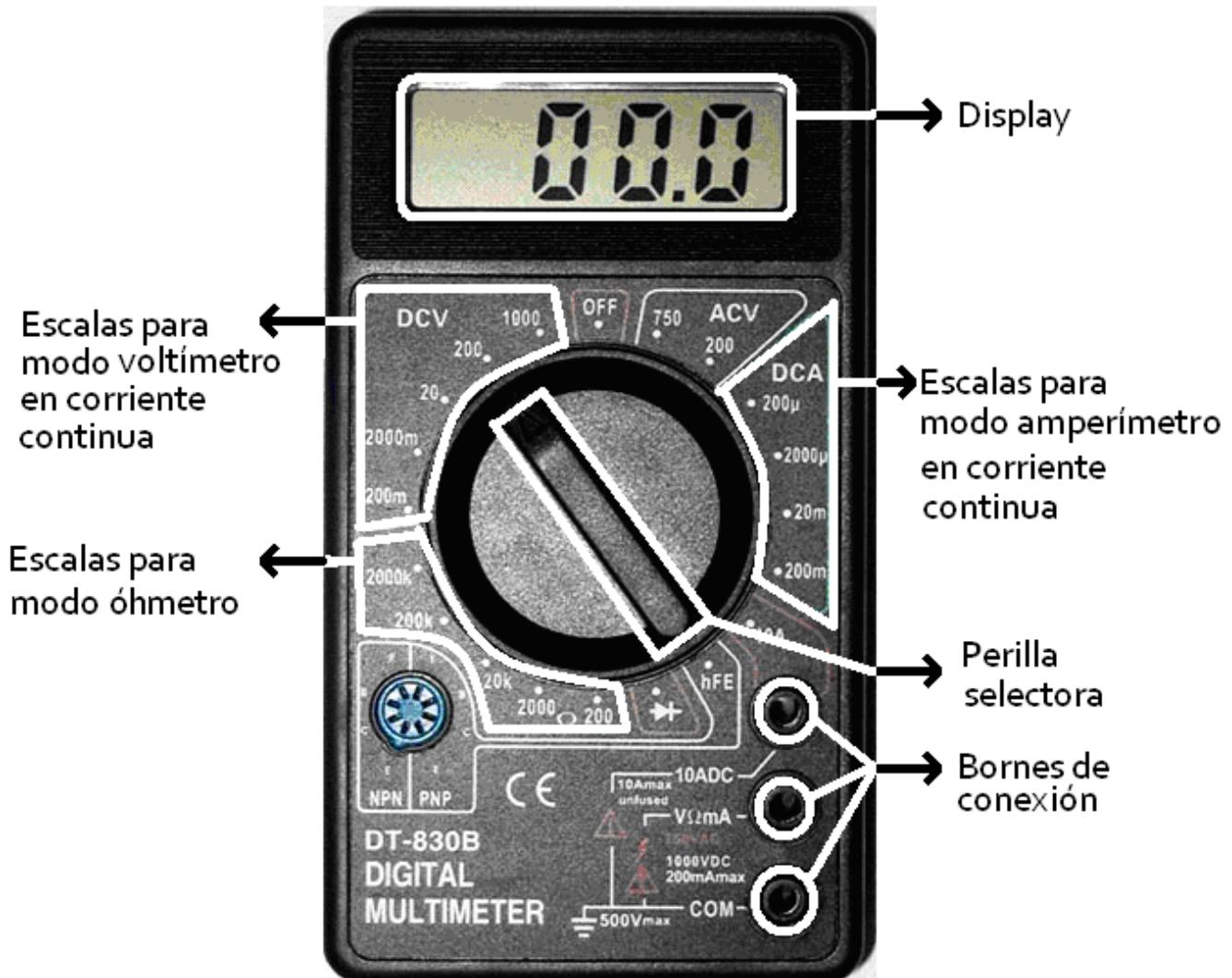
Figura III. Un multímetro digital.
