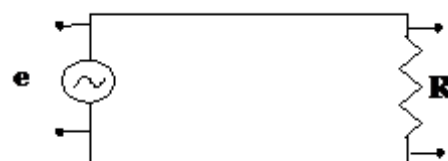
Figura III: circuito compuesto de una fuente de tensión alterna y una resistencia
