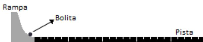
Figura I: esquema del dispositivo experimental
